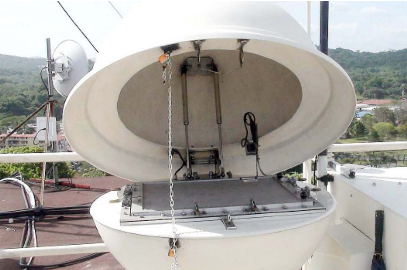
Aspiradora “Snow White” que recoge las partículas del aire.
